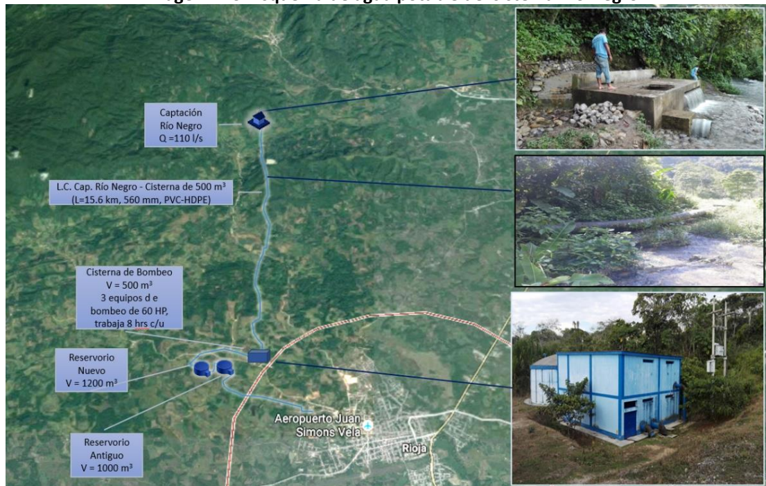
Imagen N° 3: Esquema de agua potable del sistema Rio Negro
